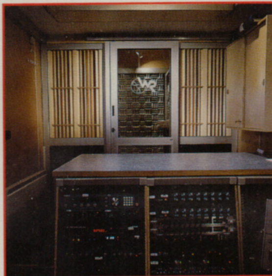
Bussens bakre del, med maskinrummet bakom glasdörren. I förg runden effekt-rackarna med all bearbetnings-utrustning.
