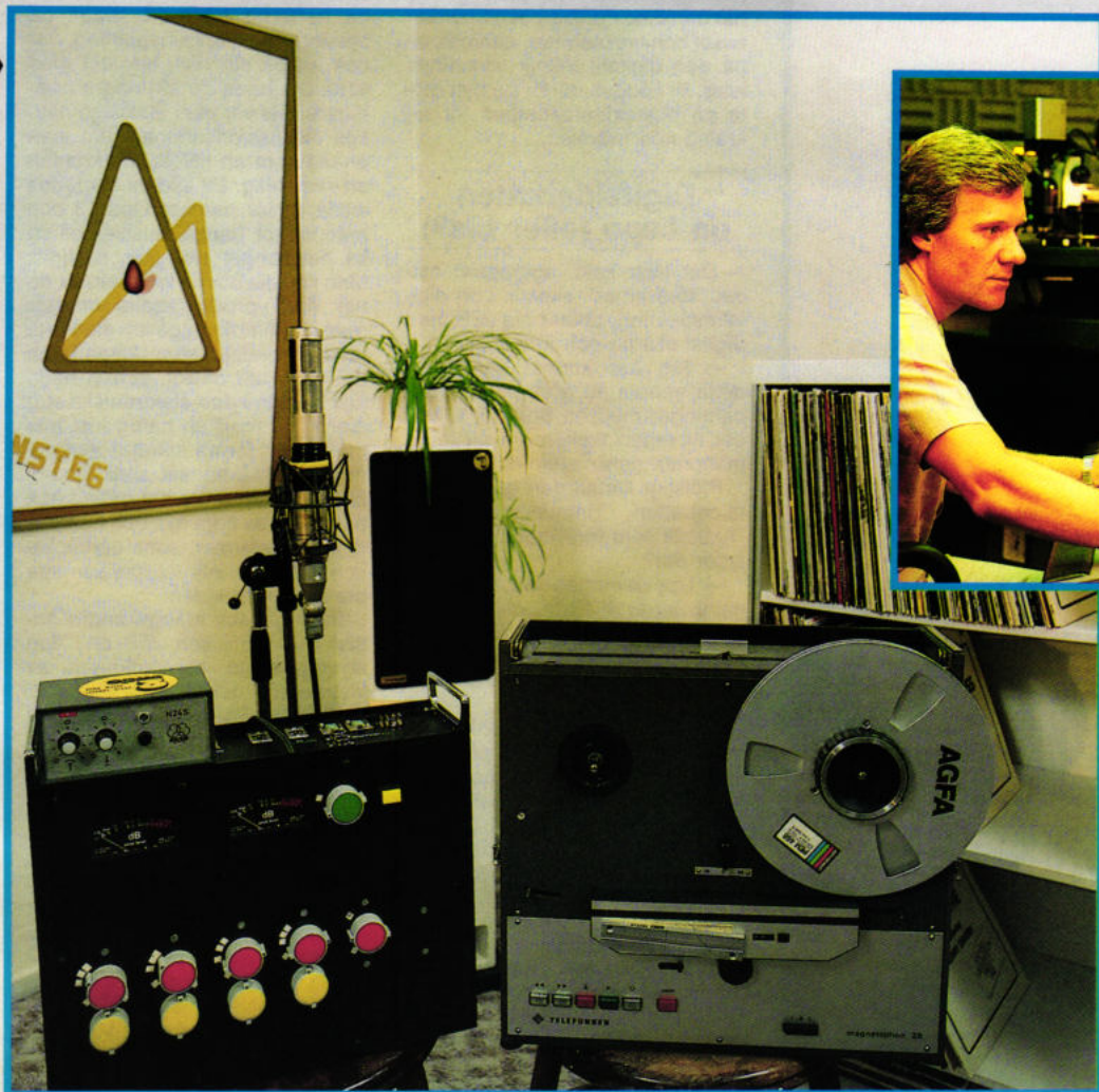
En bild av den samlade Opus 3-tekniken med rörmaterielen inkluderad: I förgrunden den rörbestyckade mixern, på sitt stativ den gamla C-24:a mikrofonen (stereo-) från AKG och Telefunken-bandspelaren M 28 för 2-spårsteknik. I bakgrunden skymtar Opus 3 egen högtalare, konstruktion Bo Hansson, en speciell variant av modellen Capella.
