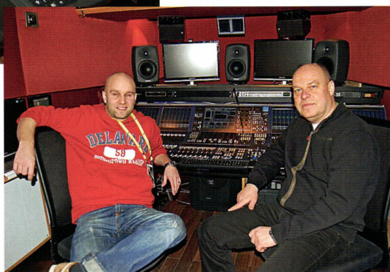
Mixerbordet är det heldigitala Lawo mc266, installerat strax före Melodifestivalen i en av Prismas ljudbussar. Mixerbordet körs av Fredrik Stålné från SVT och Ulf Östling från SR. Ljudet mixas för övrigt i 5.1-ljud.
